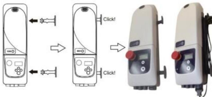
Ryc. 5. Schemat montażu haczyków na przewód zasilający.
