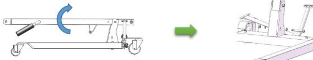
Ryc. 2. Schemat montażu masztu podnośnika.
